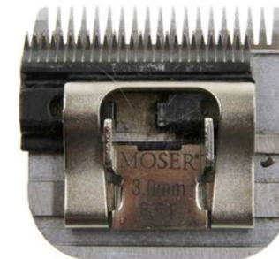
Traces d'usure dues au graissage insuffisant
